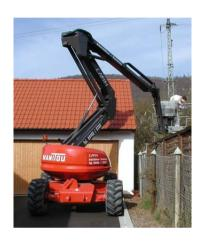
Ladekapazität 250 kg Arbeitskorb L x B 1,70 x 0,90 m Arbeitshöhe 16,70 m Reichweite 10,60 m 8000 kg Gewicht Steigfähigkeit 35 % Schwenkbereich der Bühne Endlos Schwenkbereich der Plattform 180° -90° / +90° Korbarm Max. genemigte Neigung 9% od. 5° Kraftübertragung 4 Lenk / 4 Antriebsräder Allradlenkung / Krabbengang Pendelachse Antrieb Diesel
